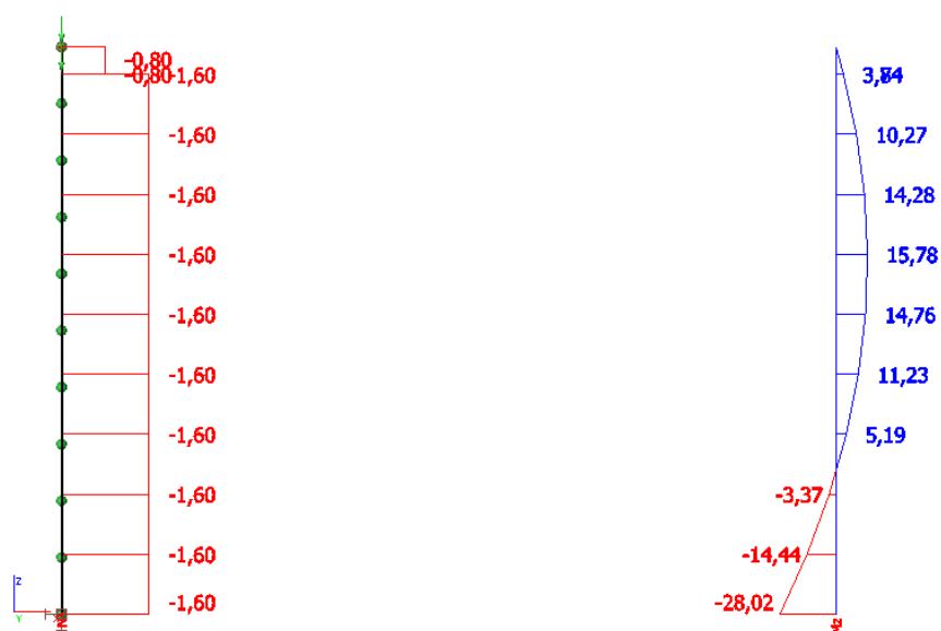
Obr.43: Průběh N [kN] a M [kNm] na sloupu od zatížení větrem 2.b
