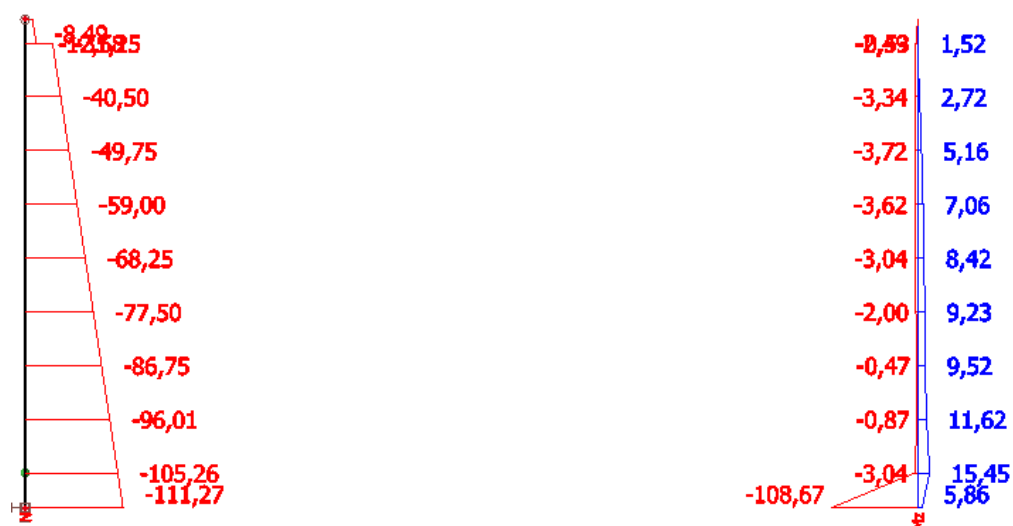
Obr.74: Průběh N [kN] a M [kNm] na štítovém sloupu při mimoř. kombinaci
